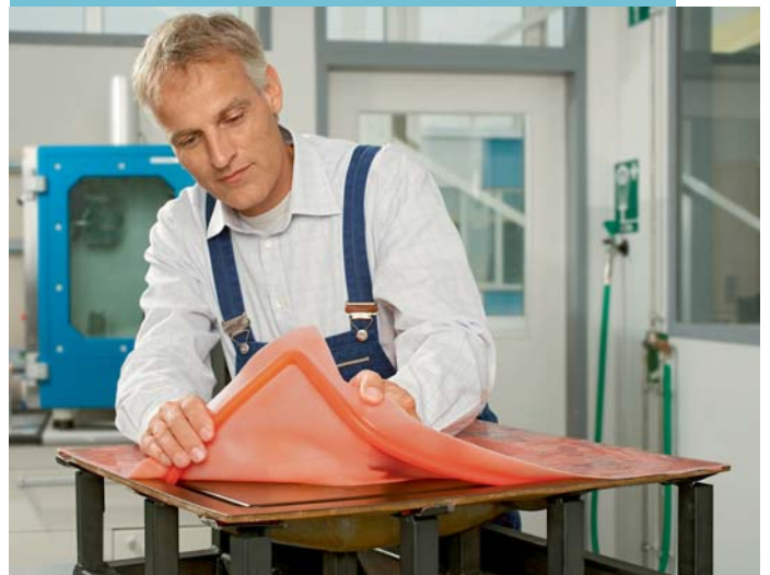
Lamineringsform med återanvändningsbar vakuumduk för tillverkning av mindre serier
